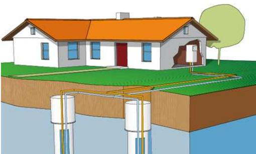
I recenti sviluppi tecnologici ora permettono, attraverso l'uso di particolari apparecchiature, dette **pompe di calore**, di sfruttare il calore della Terra anche
